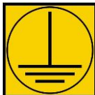
Etiqueta de aterramento
